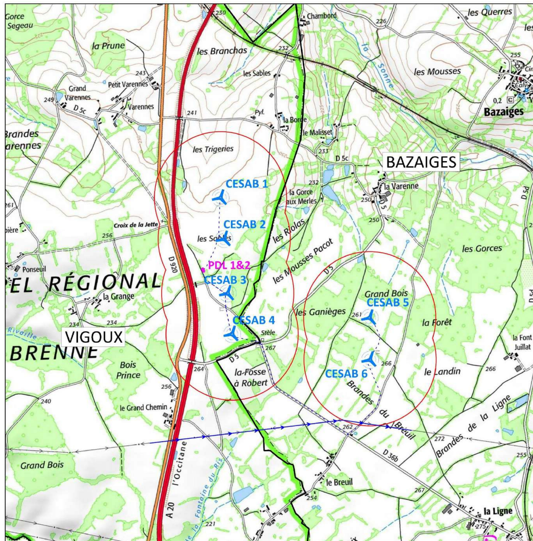
Figure 22 : Localisation du réseau inter-éolien (source : VOL-V)
